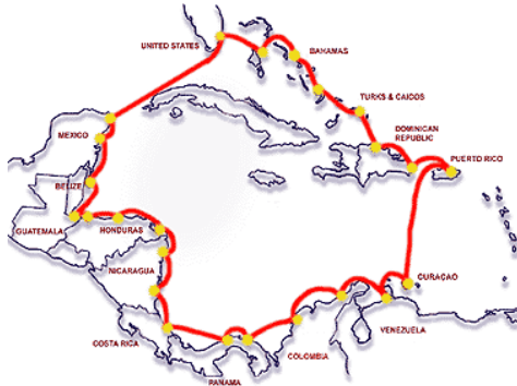
Cable ARCOS , DWDM SDH, 15 Gbps Servicios ancho de banda desde 2Mbps Submarino, entre ciudades, extremo-extremo
